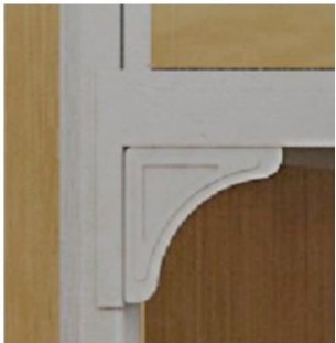
样品 6、床横梁下方三角形加固件小样 (未喷漆 1 个)：横梁下方设计三角形加固件，规格 125mm×125mm，外侧面为弧形设计，内设计两个外形接近三角形的加强筋设计，两边长各不小于 90mm、60mm。如下图所示。
